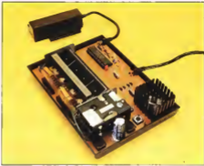
Figura 6 - L'interno dell'Alphacon e in alto a sinistra si nota il dissipatore di calore, in rete verticali.
